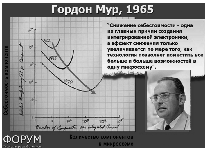
Рис. 16. Динамика снижения стоимости микросхем с ростом количества компонентов в микросхеме
